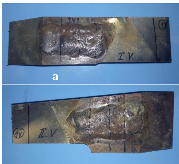
Obrázok 3 Vzorky s vrstvou návaru a - vzorka IV s návarom OK 85.65; b – vzorka IIV s návarom OK 84.58
