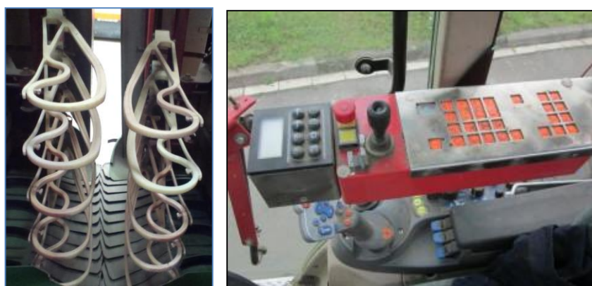
Obrázok 4 Striasacie ústrojenstvo a ovládanie z kabíny
