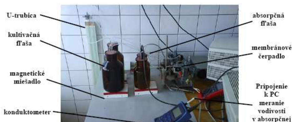
Obrázok 3 – Modifikácia testovacej aparatury pre meranie rozložiteľnosti prostredníctvom kontinuálneho a paralelného merania spotreby O 2 a produkcie CO 2
