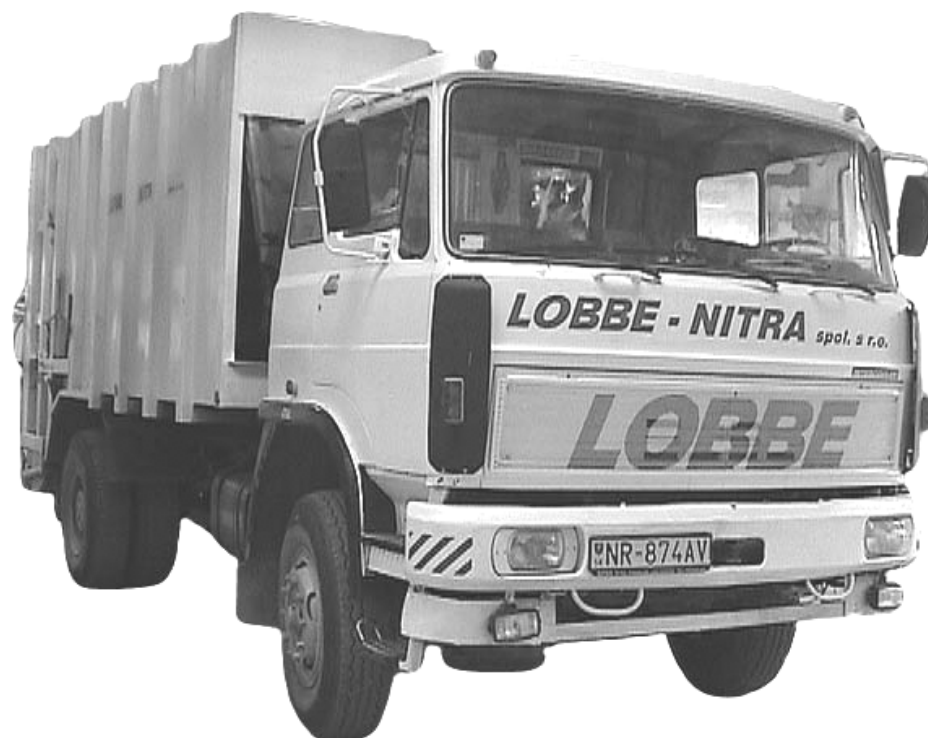
Obrázok 1 Testované komunálne vozidlo LIAZ 110 830 Unimatic
