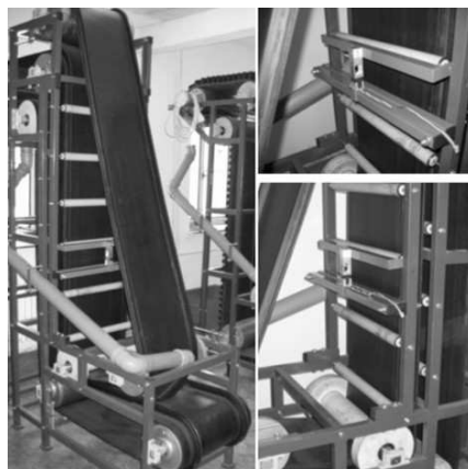
Obr. 7 Snímání síly do přítlačného válečku na poloprovozním modelu svislého pásového dopravníku s krycím pásem
