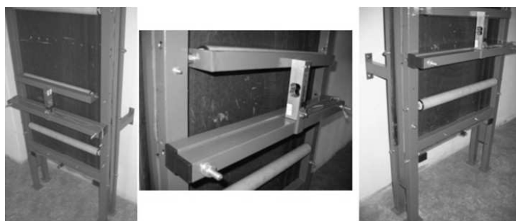
Obr. 6 Snímání síly do přítlačného válečku ve svislé šterbině statického modelu svislého pásového dopravníku s krycím pásem
