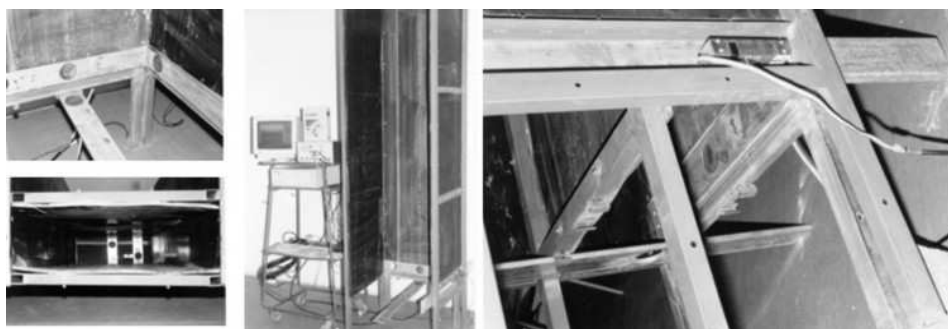
Obr. 4 Měřicí stanoviště určené ke snímání tlaku sypké hmoty do plochy dopravních pásů a dna štěrbin
