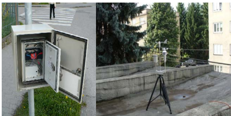
Obr. 2 Radarové sčítacie zariadenie SIERZEGA SR4 (vľavo) a meteorologická stanica WS 888 (vpravo).
