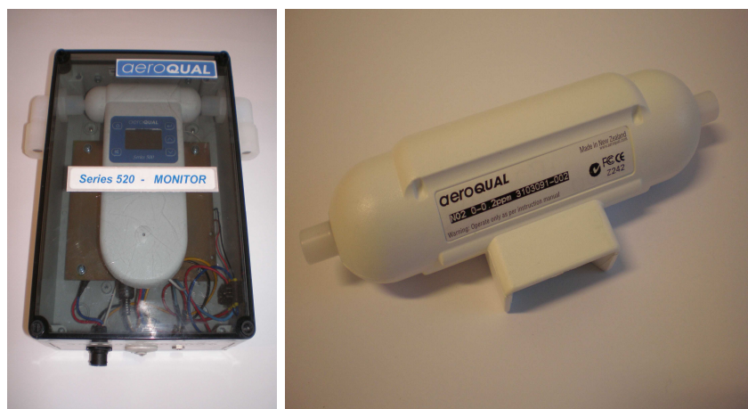
Obrázok 1 Prístroj Aeroqual 520 upravený pre vonkajšie použitie (vľavo) a monitorovacia hlava pre plyn \text{NO}_2 (vpravo)
