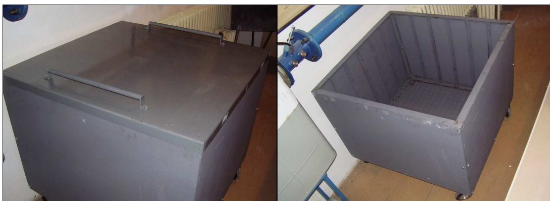
Obrázok 3 Základná konštrukcia experimentálneho modelu miestnosti
