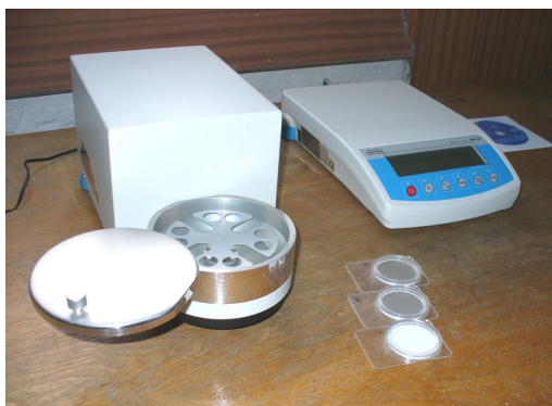
Obrázok 1 Meracie stanovište na diaľnici D1 a gravimetrické vyhodnocovanie filtrov v laboratóriu
